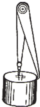
圖 3-1 用單腳卡求中心
