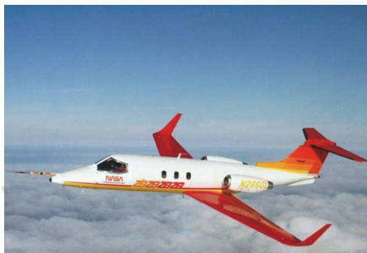
1.4 在翼尖安裝翼尖小翼可減少誘導阻力(圖/取自 NASA)
