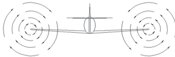
圖 1.1 機翼上下表面壓力差所形成之漩渦
