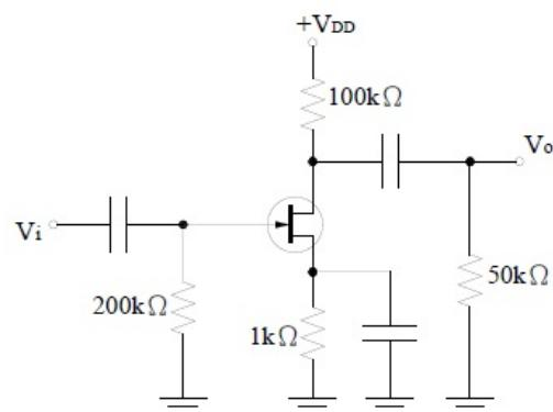
(D) 46. 如右圖所示之電路，已知 JFET 之  $I_{DSS} = 4mA$ ，夾止電壓  $V_P = -4V$ ，汲極電阻  $r_d = \infty$ ，則電壓增益  $A_v$  為多少？
