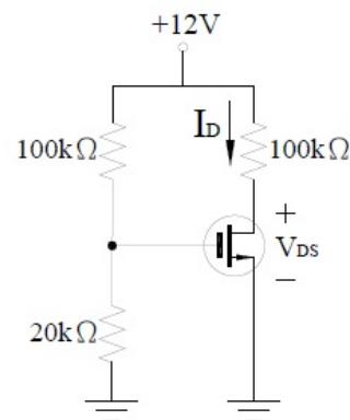
(C) 45. 如右圖所示之電路，若  $g_m = 2mA/V$ ， $r_d = 100k\Omega$ ，則 JFET 共源極放大電路的電流增益  $A_i$  為多少？
