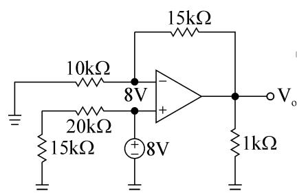
$\because V_+ = 8 (\text{V})$ ， $V_- = V_+ = 8 (\text{V})$ ，故利用節點電壓法，則：
