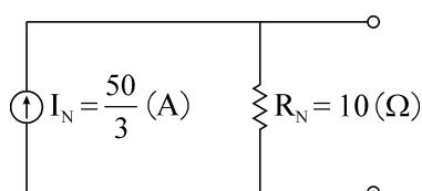
(二) 戴維寧等效電阻  $R_{th} = R_N = 10 \text{ (\Omega)}$ ，戴維寧等效電壓  $E_{th} = 500/3 \text{ (V)}$
